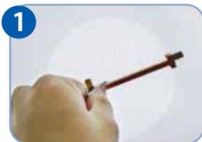
コンパスカッターを用いて直径15cmの穴を開けます。
